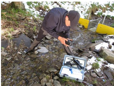
Slika 92. Meritve kakovosti vode v potoku s prenosnim merilnim instrumentom HQ40d Multi meter (HachLange) (foto: Urša Vilhar)
