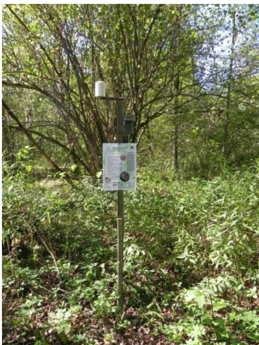
Slika 94. Avtomatski merilniki na monitorinški lokaciji Gameljne - Tacen, raziskovalna ploskev P2 (topol), za kontinuirane meritve temperature zraka na višini 2 m, vsebnosti vlage v tleh in temperature tal na globini 0,1 in 0,3 m (foto: Urša Vilhar)
