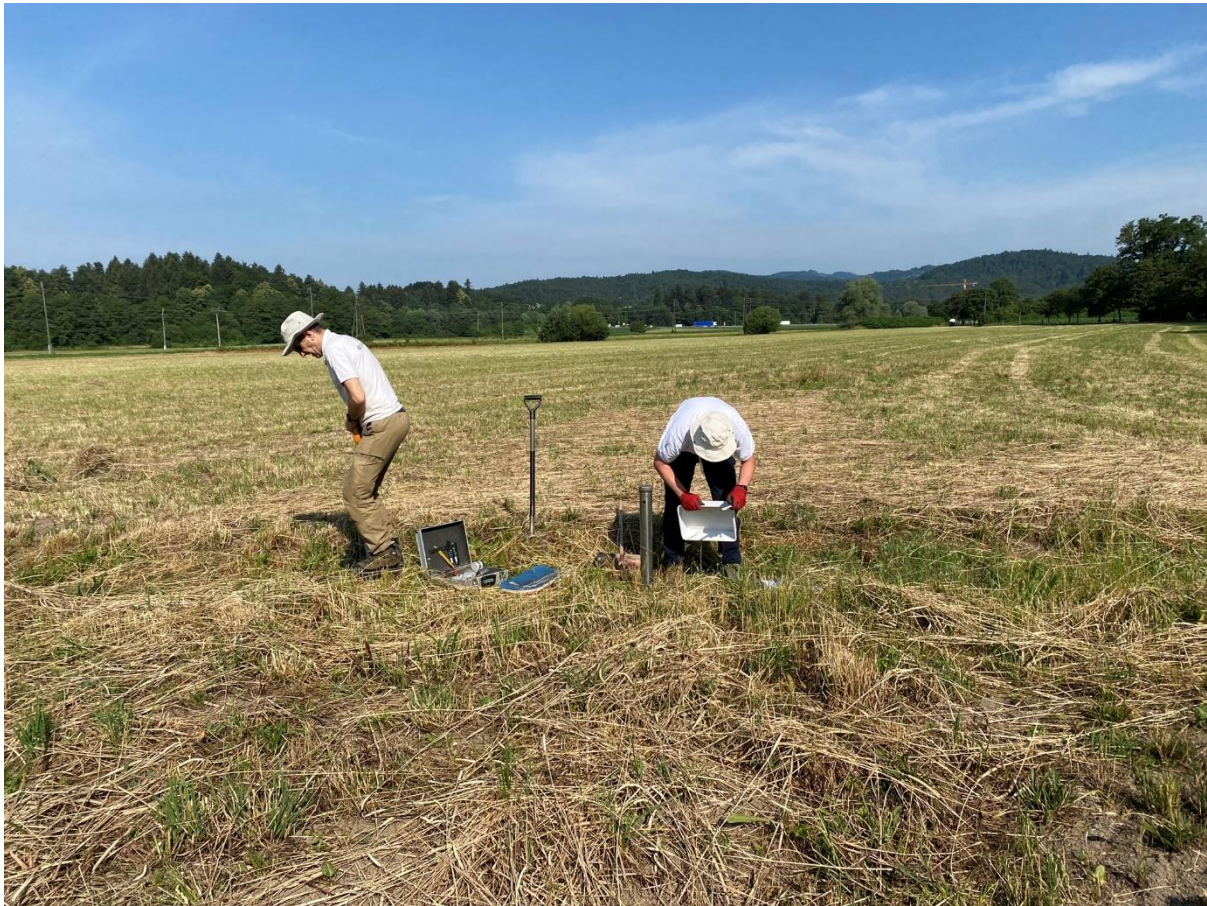
Slika 3: Odvzem porušenih vzorcev tal po 10 cm korakih do globine 30 cm s cevasto sondo premera 6,7 cm.
