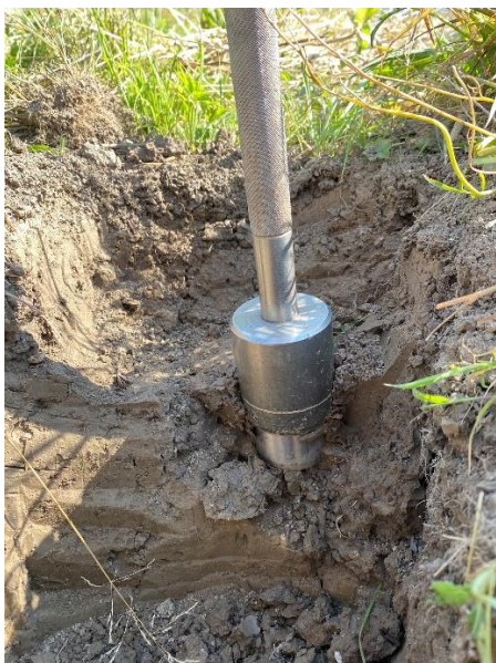
Slika 4: Jama za vzorčenje na odzemnem mestu in s Kopecky cilindrom odvzet neporušen vzorec tal.
