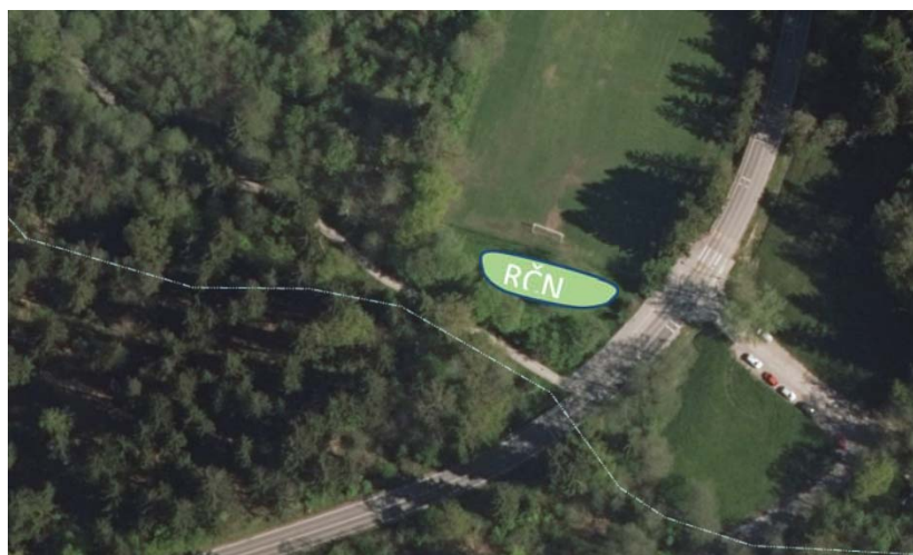
Slika 5: Situacija in potencialna umestitev rastlinske čistilne naprave za čiščenje drenažne vode z nogometnega igrišča pred izlivom v potok Mostec.
